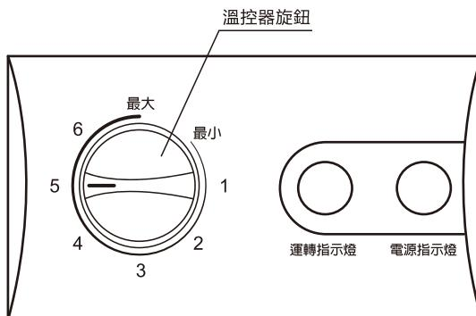
☆ 使用說明如下: 插上插頭後, 電源指示燈亮啟, 表示已經開機完成; 請將溫控器旋鈕轉至檔位 “5” 後靜置數小時, 待內部溫度達低溫後, 再將食物放入。
