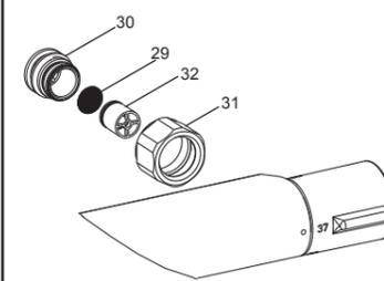
濾網墊片(29)可起到保護龍頭的作用，但長時間使用後，水垢或雜質可能會堵塞濾網，降低水流量。如果有類似情況發生，卸下龍頭，用六角扳手(12mm)將底座(30)，順時針)擰下，取下螺母(31)、濾網墊片(29)以及單向閥(32)。用熱醋清洗濾網。然後按照圖示裝回。(注意：單向閥必須按原方向裝回)。
