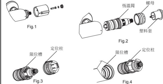
如果供水的水質較硬或長時間使用，水垢或雜質會阻塞溫控閥上的濾網，流量會降低。需要清理請按照下列步驟進行：關閉供水系統，使流量閥處於打開位置後進行溫控閥的拆卸作業。溫控閥是較精密的配件，所以要十分小心。
