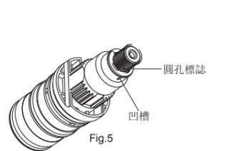
**注意：**確保拆卸安裝過程中，不要轉動溫控閥軸。如不小心轉動了閥軸，要調整閥軸使外齒上的圓孔標誌與相鄰的塑套上的凹槽對齊(Fig.5)，或者按前述方法調整。
