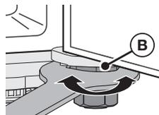
3. 一旦門校平之後，以逆時針方向（↺）轉動夾緊螺母（A）將其鎖緊。
