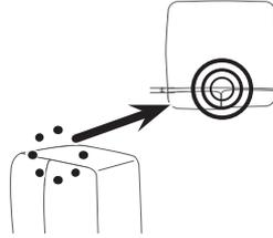
1. 打開與冰箱間隙較窄的那扇門，然後以逆時針方向（↻）轉動調整器直到間隙平均。
