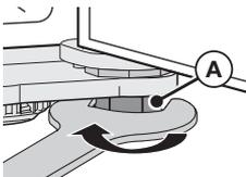
2. 使用扳手以逆時針方向（↺）轉動調整螺母（B）來調整門的高度。（以逆時針方向（↺）轉動可增加門的高度，順時針方向（↻）則是降低高度。
