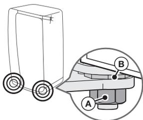
1. 打開需要進行調整的門，使用產品包裝中隨附的扳手，以順時針方向（↻）轉動鬆開門底部的夾緊螺母（A）。（首先抬起兩扇門中較低的一扇。）
