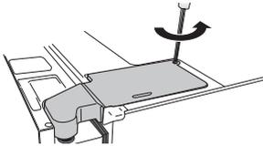
3. 以順時針方向（↻）旋轉螺栓來加寬間隙。以逆時針方向（↻）旋轉螺栓來縮減間隙。調整冷藏室門和冷凍室門之間的不平均直到平均為止。
