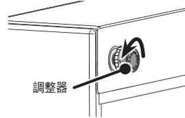
2. 門與冰箱間的間隙調整好之後，以順時針方向（↻）轉動調整器螺母直到將調整器鎖定到位。
