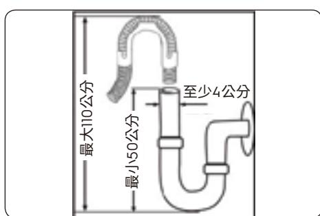
將排水管直接連接到排水孔或水槽的出口栓。這個接線應距離地板至少50公分，最大110公分。
