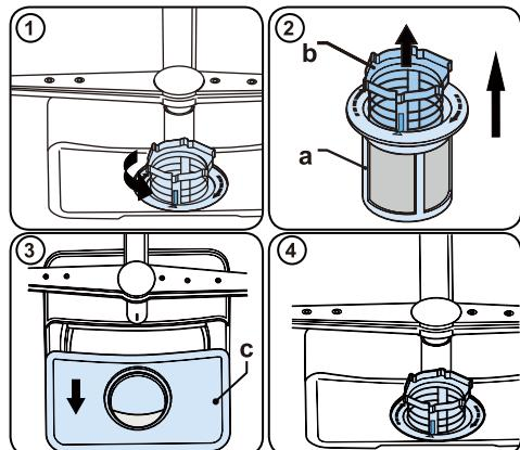
欲取下並清潔濾網組，應逆時針旋轉它，然後往上拉便可取下(1)。將粗濾網從細網器(2)中拉出。接著拉出並取下金屬濾網(3)。用大量的水沖洗濾網，直到完全清除殘餘物。重新安裝濾網。放回濾網，然後順時針旋轉(4)。
