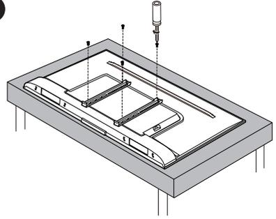
將掛架放在顯示器上。使用從後殼上取下的螺絲固定掛架。
