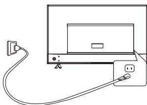
2. 先將電源線與顯示器相連，然後將電源線插頭插到交流電源插座上。（注意：如果電源線已經連接到顯示器，請直接將電源線插頭插到交流電源插座上。）
