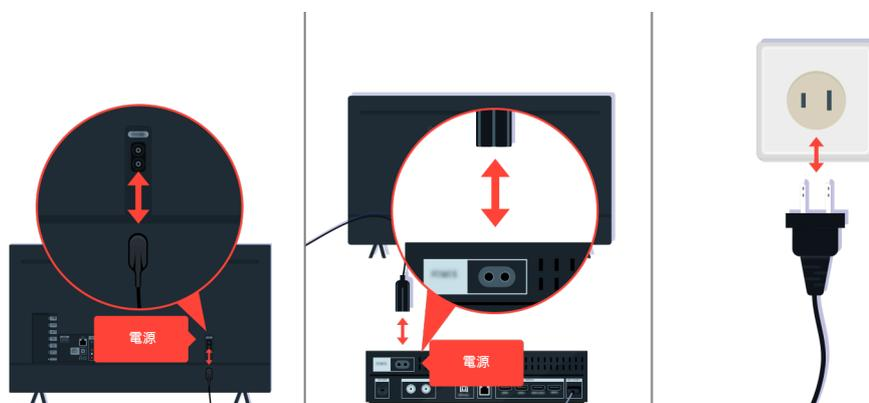
首先，中斷連接電源線及電視或 One Connect 盒背面的 HDMI 纜線，再重新接上，然後拔掉電源線插頭，再將插頭插入牆壁插座。
