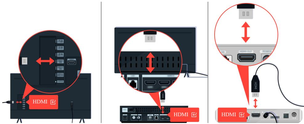
首先，中斷連接電源線及電視或 One Connect 盒背面的 HDMI 纜線，再重新接上，然後拔掉電源線插頭，再將插頭插入牆壁插座。
