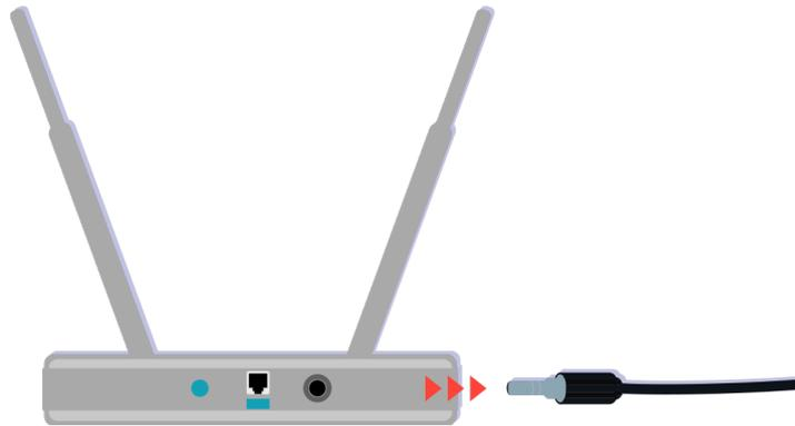
嘗試拔除再重新連接電源接頭來重新啟動存取點。重新開機後需要 1 至 2 分鐘時間，存取點才能恢復連線。
