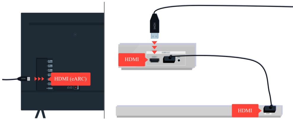
如果聲棒有連接接收器，而且使用 an HDMI 纜線連接 電視 與接收器，請檢查 電視 背面的 HDMI 接頭。纜線必須連接 電視 的 HDMI (eARC) 連接埠。
