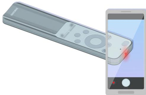
您可以按下電源按鈕，並透過智慧型手機的相機觀察遙控器前方尖端，檢查是否正在傳輸訊號。
