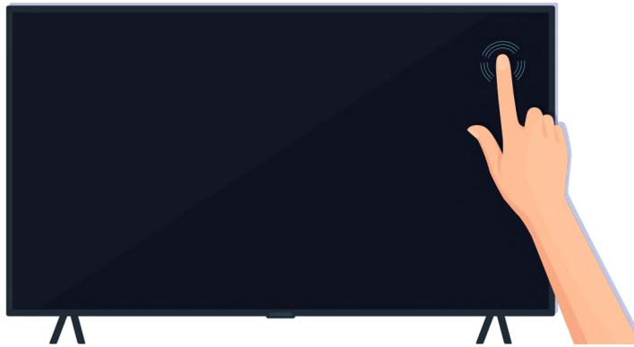
如果電視畫面仍在閃爍，請以手指輕點。如果您輕點的部分畫面閃爍，表示電視的電源供應器連接正確。
