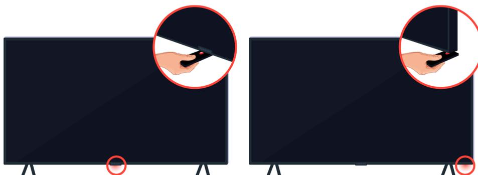
手握反射物體如鏡子並放在 電視 下面，即可輕鬆找到遙控感應器。
