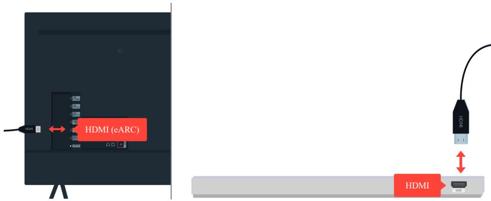
如果聲棒沒有聲音，如果使用 HDMI 纜線連接 電視，請檢查 電視 背面的 HDMI (eARC) 接頭。
