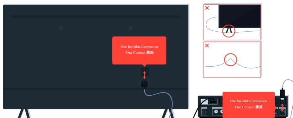
中斷連接 電視 及 One Connect 盒之間的 One Invisible Connection 或 One Connect 纜線，然後重新連接。確保 One Invisible Connection 或 One Connect 纜線 沒有擠壓或大幅度折彎。
