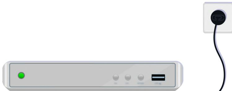
如果未開啟，請確定電源線已正確連接裝置和牆上插座。
