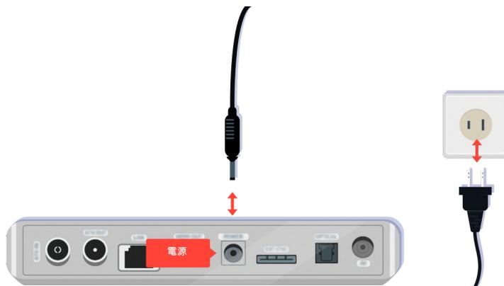
如果未開啟，請確定電源線已正確連接裝置和牆上插座。
