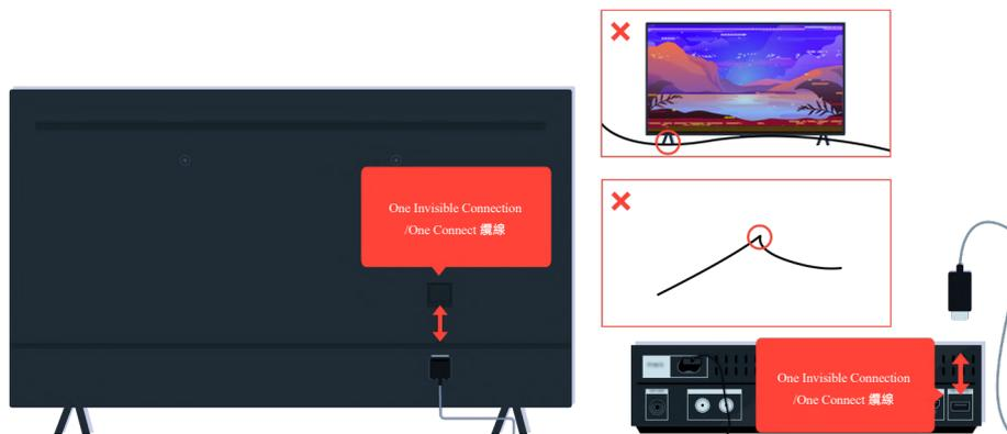
如果問題仍然存在，而且您的電視使用 One Invisible Connection 或 One Connect 纜線，請中斷連接 One Invisible Connection 或 One Connect 纜線後，再重新連接電視及 One Connect 盒。確保 One Invisible Connection 或 One Connect 纜線沒有擠壓或大幅度折彎。
