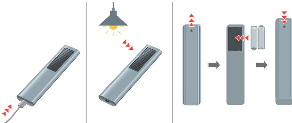
若您沒看到紅外線訊號，請使用底部的 USB 連接埠 (C 型)，或翻轉遙控器以暴露太陽能電池，藉此為遙控器充電。若遙控器有電池，請更換為新的電池。
