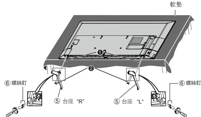
步驟 ① 將支架裝配插入顯示器底部的開口中。
