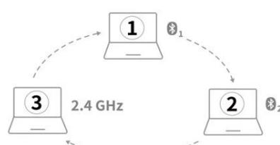
按住藍牙鍵，最多可在一台2.4G設備和兩台藍牙設備之間循環切換。切換到2.4G設備，指示燈滅；切換到藍牙設備A，綠燈快閃；切換到藍牙設備B，藍燈快閃。
