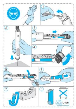
依圖示打開刷柄取出電池,回收電池請根據 當地環境法規將整組產品丟棄。
