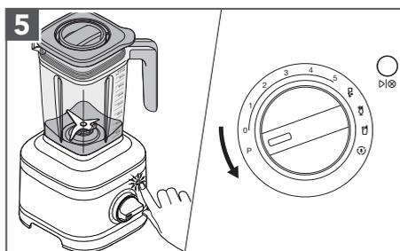
**Pulse (瞬升轉速) 模式：**按下 (▷)⊙。按照所需的間隔時間來旋轉控制旋鈕，從 (O) 旋轉至 (P) 不放。
