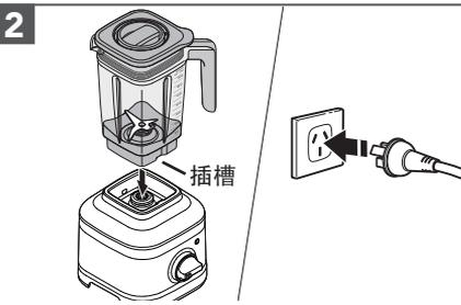
对准插槽，将搅拌机放在底座上的搅拌杯垫内，使搅拌杯手柄朝向控制钮。
