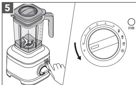
**脉冲模式：**按下 (P)。根据所需的间隔时间，按住控制钮从 (O) 转至 (P)。完成后，释放控制钮以停止。
