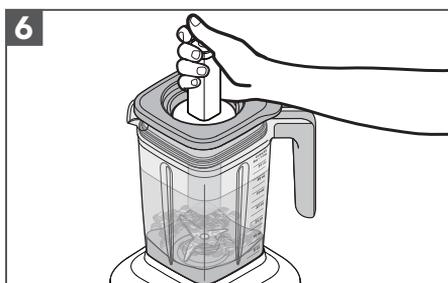
**壓杆配件：**只要取下「杯蓋中央套」即可。攪拌食材或將食材朝刀頭方向下壓。然後，在繼續攪拌前，將杯蓋中央套放回原位。
