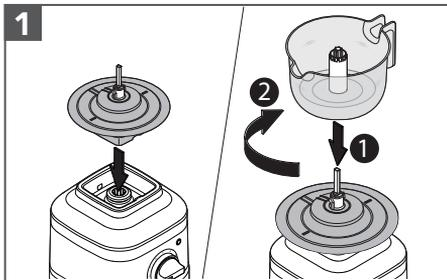
將齒輪組件放置在底座上。將果汁容器放置在齒輪組件上，順時鐘方向旋轉直到控緊為止。
