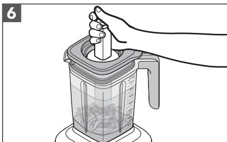
**推压棒配件：**仅取下杯盖中心盖。搅拌或向下挤压内容物，以便其接触刀片。然后，在恢复搅拌之前，将杯盖中心盖放回。
