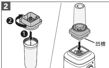
將刀鋒組件牢牢放置在攪拌杯上，以順時鐘方向旋轉直到拴緊為止。
