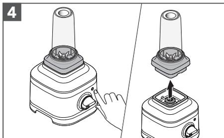
按下 (▷|◻), 机器停止运行。请务必将装有刀片组件的随身搅拌杯或小批量搅拌杯从底座上卸下。
