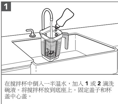
在搅拌杯中倒入一半温水，加入 **1** 或 **2** 滴洗碗液。将搅拌杯放到底座上。固定盖子和杯盖中心盖。
