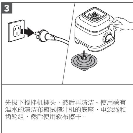
先按下搅拌机插头，然后再清洁。使用蘸有温水的清洁布擦拭榨汁机的底座、电源线和齿轮组，然后使用软布擦干。
