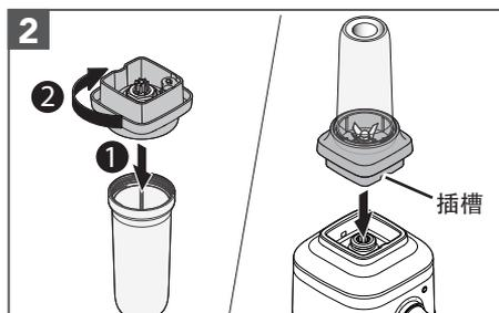
将刀片组件固定在搅拌杯上，顺时针拧动，直至将其拧紧。
