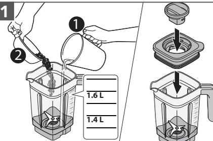
在搅拌杯内加入原料（最多 1.6 L，玻璃搅拌杯则最多 1.4 L）。固定盖子和杯盖中心盖。
