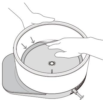
※拆卸時，請從鋁製加熱器的交界處拉動比較容易拆卸。
