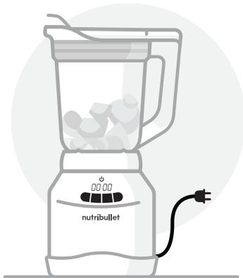
5. 將主機電源接上插座，並按下 POWER 鍵開啟電源。若上蓋與主機都有完全卡入卡榫，主機面板將顯示可操作選項。
