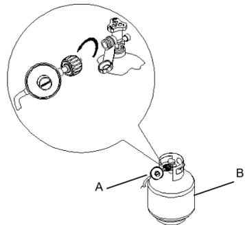
A. 燃氣壓力調節器/軟管組件
