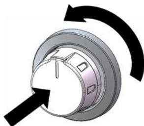
4. 你會聽到火花的「爆裂」聲。燃燒器點燃時，釋放旋鈕。將旋鈕轉到所需設定。
