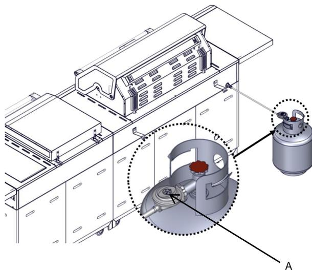
A. 燃氣壓力調節器/軟管組件
