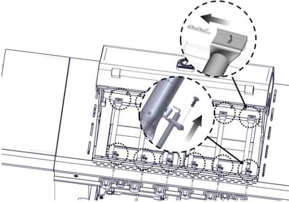
3. 使用手電筒通過燃燒器入口檢查燃燒器，確保沒有堵塞，如果看到任何障礙物，請使用拉直的金屬衣架清理。
