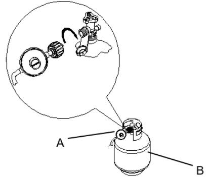
A. 氣壓力調節器/軟管組件
