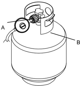
A. 燃氣壓力調節器/軟管組件
