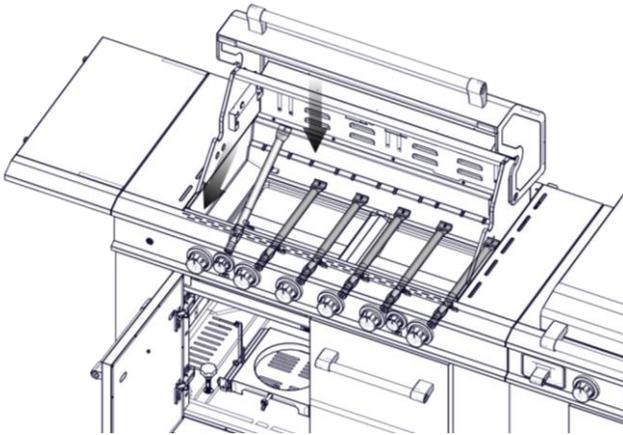
5. 使用螺栓和開口銷重新安裝燃氣燃燒器。
