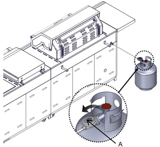
A. 燃氣壓力調節器/軟管組件
