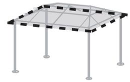
註：短橫杆 (5) 與長橫杆 (7) 已預先安裝一個連接件，用於插入安裝短橫杆 (6) 與長橫杆 (8)。
