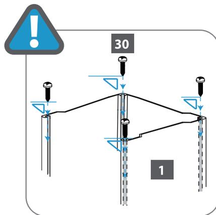
在進行步驟 4 (將本產品固定於地面) 的組裝作業之前，先將支撐框架 (2) 放在距離角型材 (1) 下端的上方約10英吋 (25.4公分) 位置。
