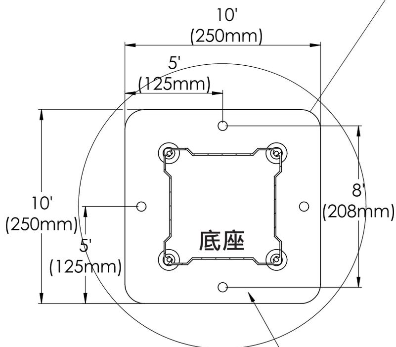
支撐柱局部尺寸 支撐柱底座
