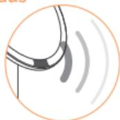
Das Licht schaltet sich automatisch ein, wenn Sie sich in einer Entfernung von max. 30 cm vor dem Spiegel befinden.
