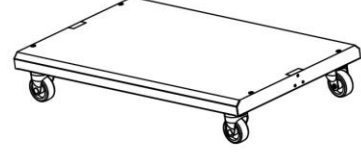
A 底架 - 1個 (腳輪已完成安裝)
